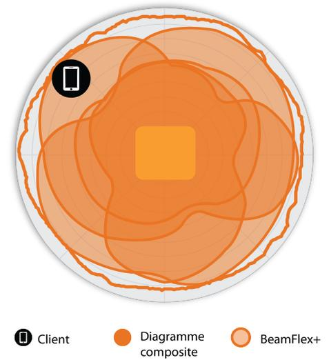
Figure 2. Diagrammes d'antennes Azimut R550 2,4 GHz
