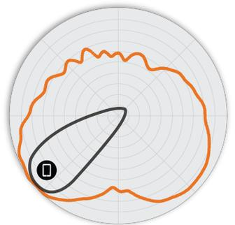
Remarque : le tracé extérieur représente l'empreinte RF composite de chaque diagramme de rayonnement BeamFlex+ possible, tandis que le tracé intérieur représente un diagramme de rayonnement au sein du tracé extérieur composite.
