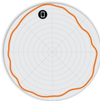
Figure 4. Diagrammes d'antennes Élévation R550 2,4 GHz
