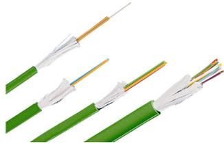
La solution "Fiber to the Desk" adaptée pour le montage direct sur les fiches. Très compact, le câble Mini Breakout est facile à installer et constitue une solution idéale et avantageuse pour les espaces exigus. Les conducteurs à structure serrée de 900µm ont chacun une couleur différente et son entourés de fils de verre.
