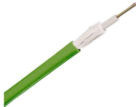
Cette construction du câble comporte un tube central rempli de gel avec un diamètre de 2,8 mm pour 2 - 16 fibres ou de 3,5 mm pour 18 - 24 fibres. La fibre de verre renforcée améliore la protection et la force de traction, ce qui en fait le partenaire idéal pour les applications de câblage secondaire (backbone) dans les systèmes de câblage générique.
