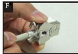
Verrouiller en appuyant sur les 2 volets latéraux métalliques
